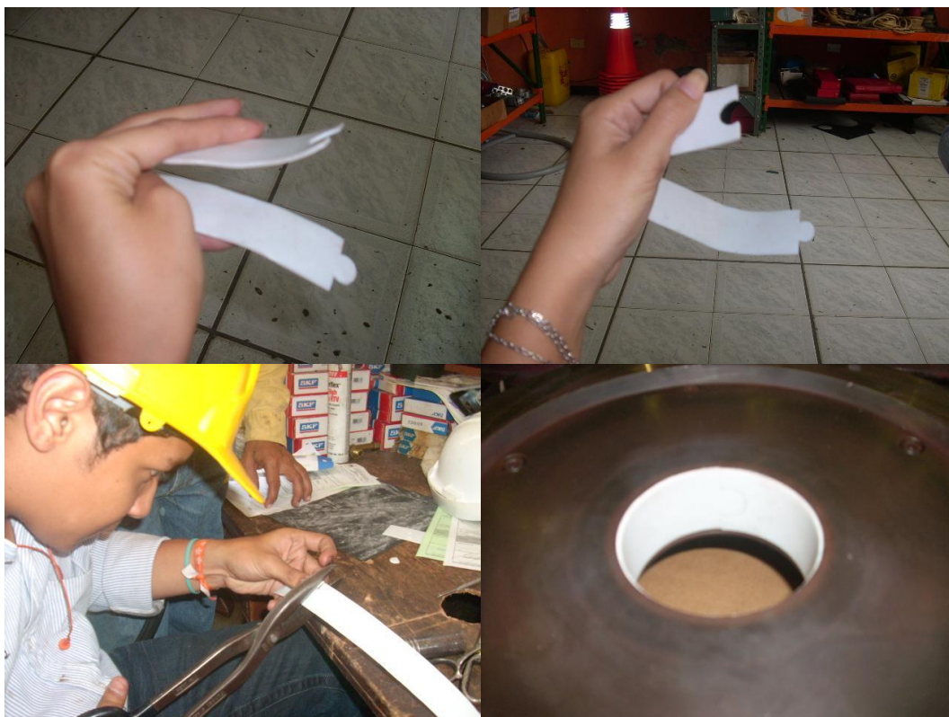
Foto 38. Cinta de teflón para el canal del difusor – Bomba de alimentar caldera 1A.
