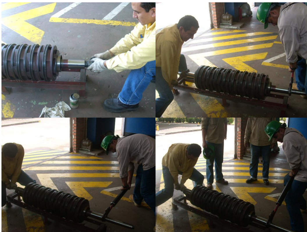
Foto 46. Apretando tuercas ajuste conjunto de piezas estáticas y móviles del eje – Bomba de alimentar caldera 1A.
