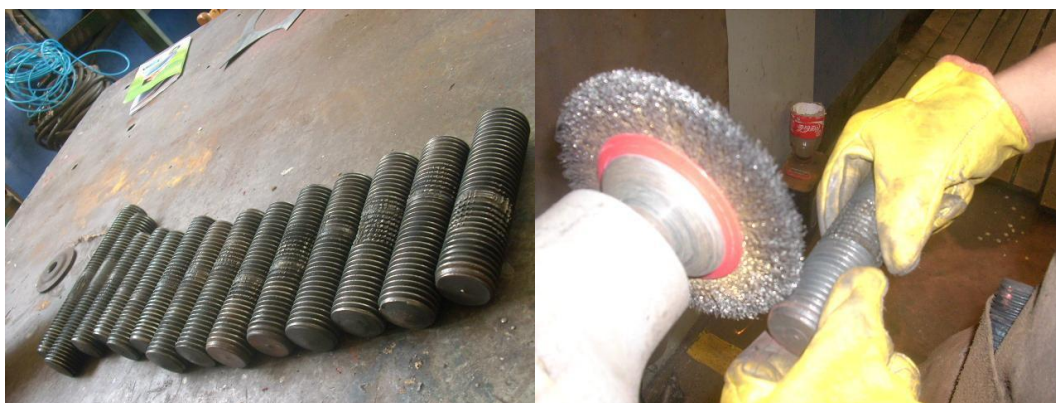
Foto 37. Limpieza espárragos con la grata – Bomba de alimentar caldera 1A.
