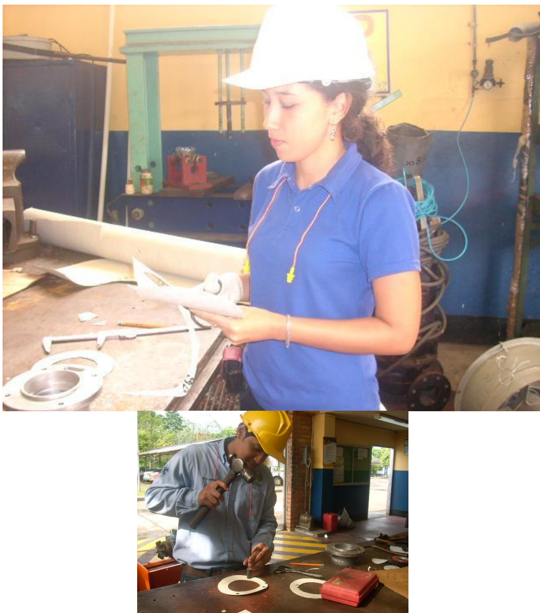
Foto 31. Empaque para sellos de aceite – Motor bomba 1A.
