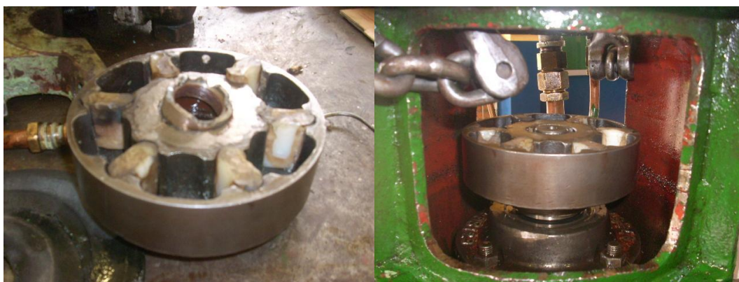
Foto 82. Acople de uña semirígido – Bomba de aceite de baja presión.
