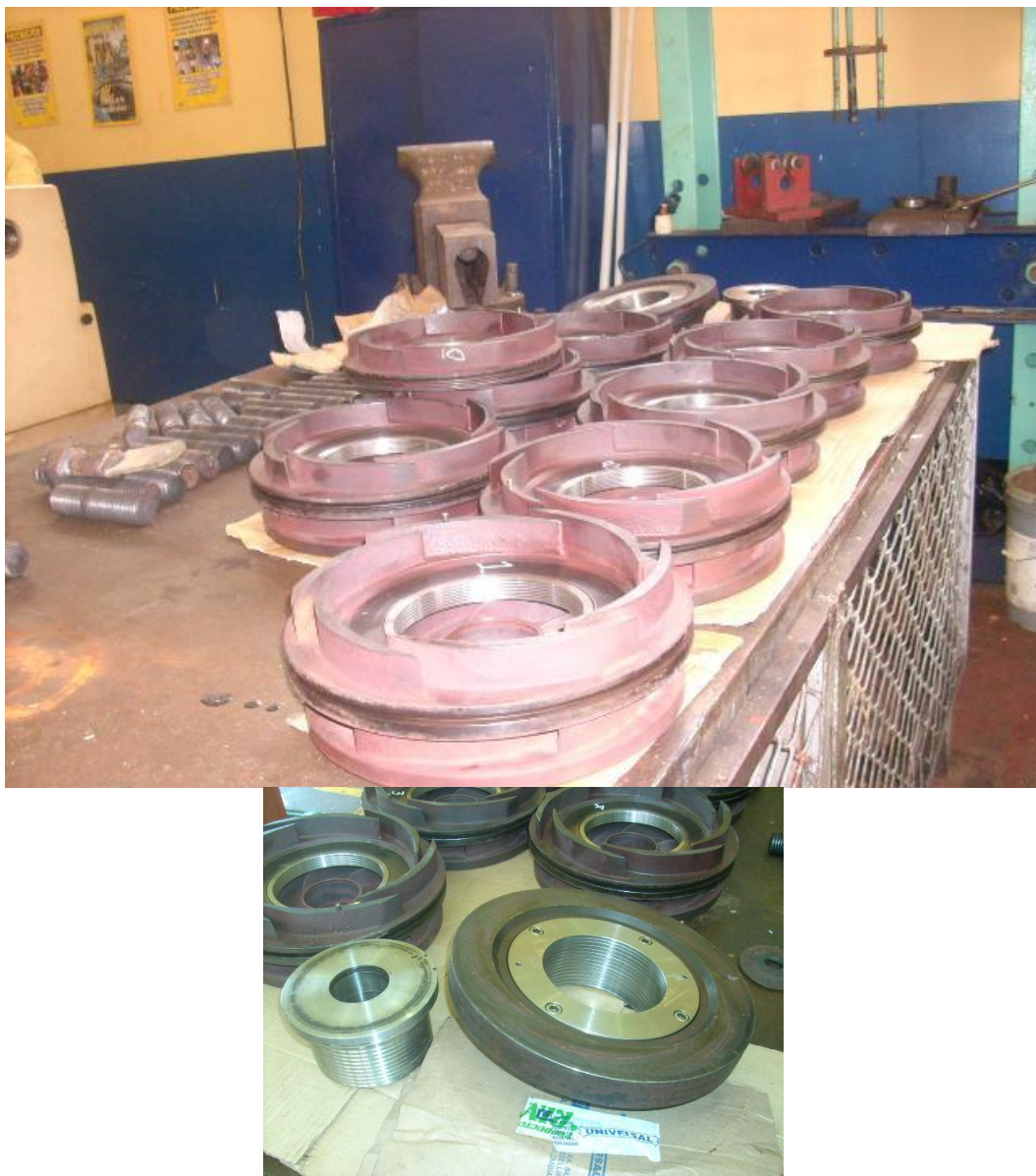
Foto 35. Piezas rectificadas, Difusores, tambor de balanceo y camisa de tambor de balanceo – Bomba de alimentar caldera 1A.
