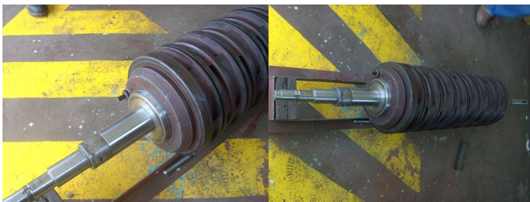
Foto 47. Conjunto ajustado de piezas estáticas y móviles del eje – Bomba de alimentar caldera 1A.
