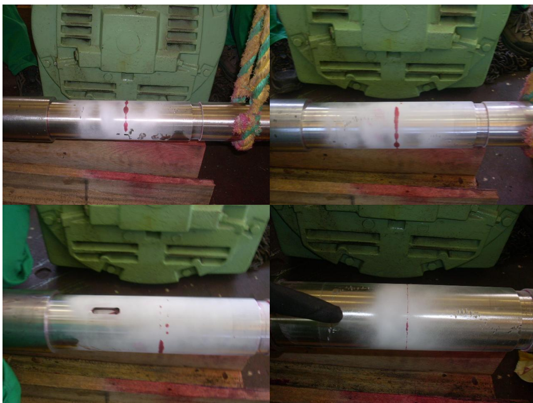
Foto 68. Prueba de tinta penetrante – Eje lado impulsor bomba de circulación 3-2.
