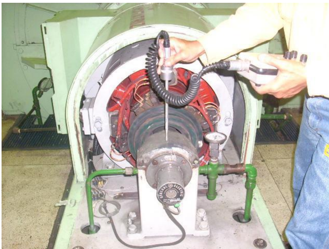
Foto 94. Prueba de vibración vertical – Turbina 1.
