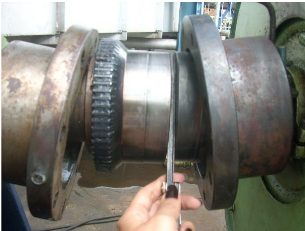
Foto 78. Medición galgas acople rápido dentado flexible(Alineamiento) – Motor del ventilador tiro forzado.
