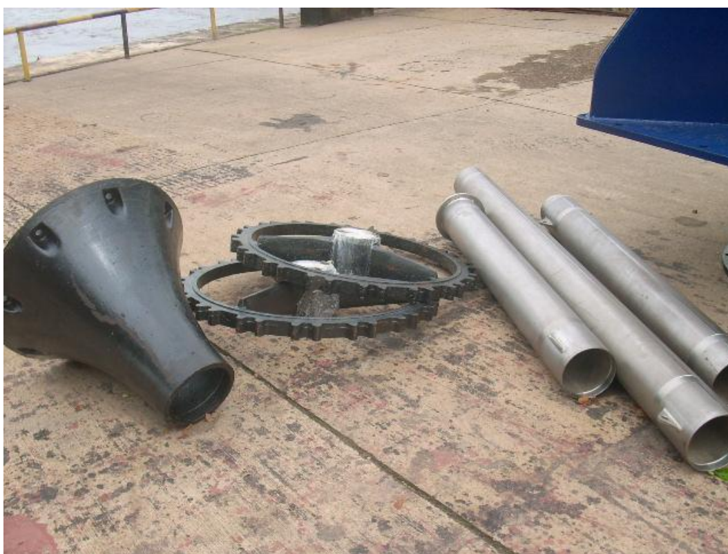
Foto 66. Deflector de flujo, crucetas, tubos porta ejes – Bomba de circulación 3-2.
