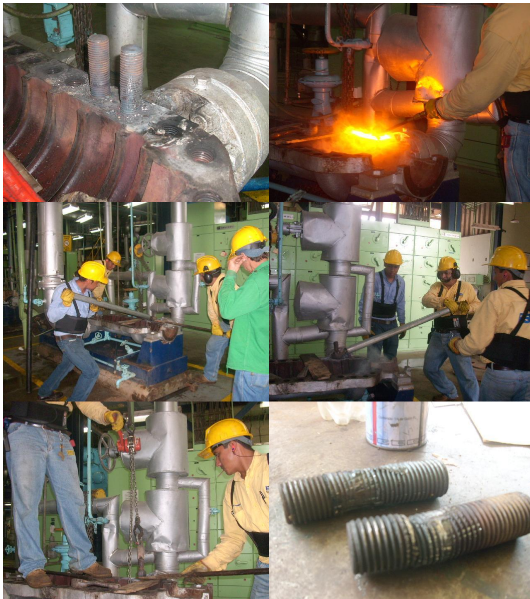
Foto 36. Espárragos dañados por deformación, maltrato en el roscado, soldadura – Bomba de alimentar caldera 1A.
