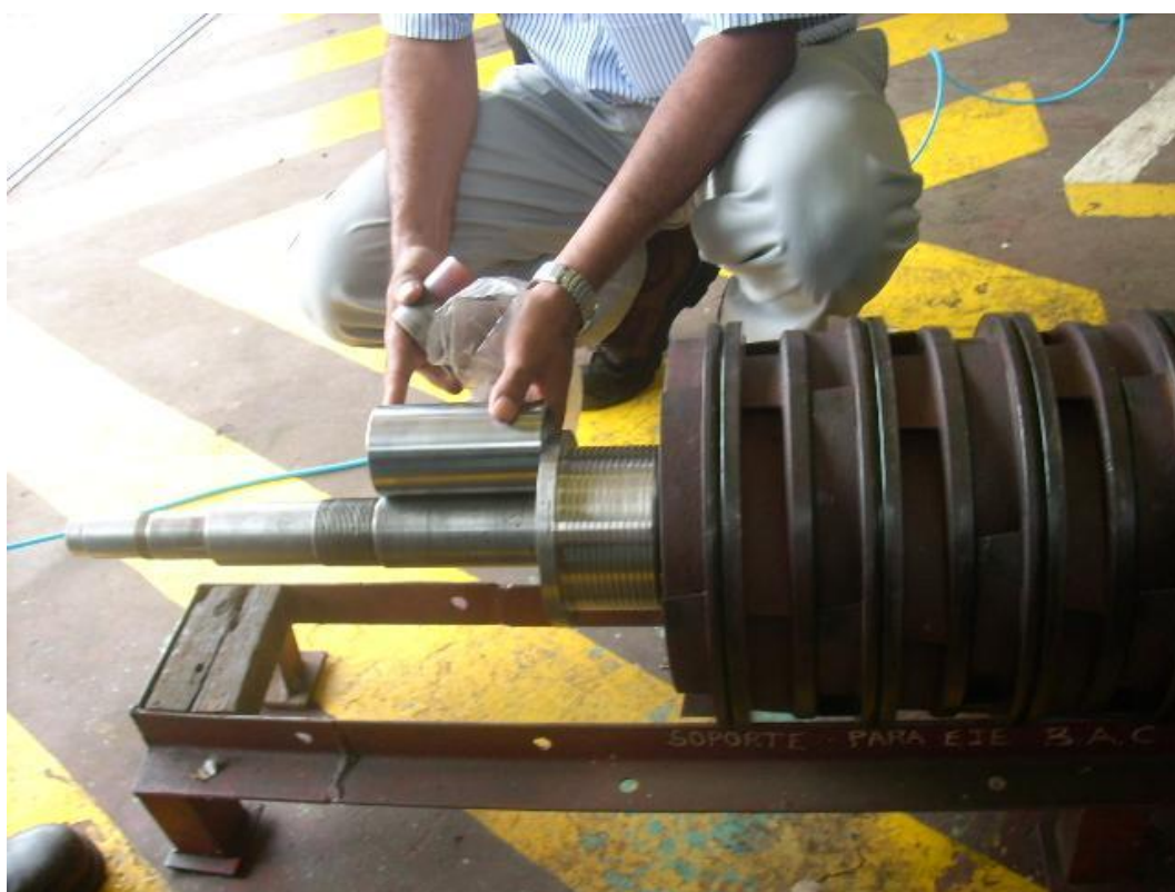
Foto 45. Camisa del eje – Bomba de alimentar caldera 1A.
