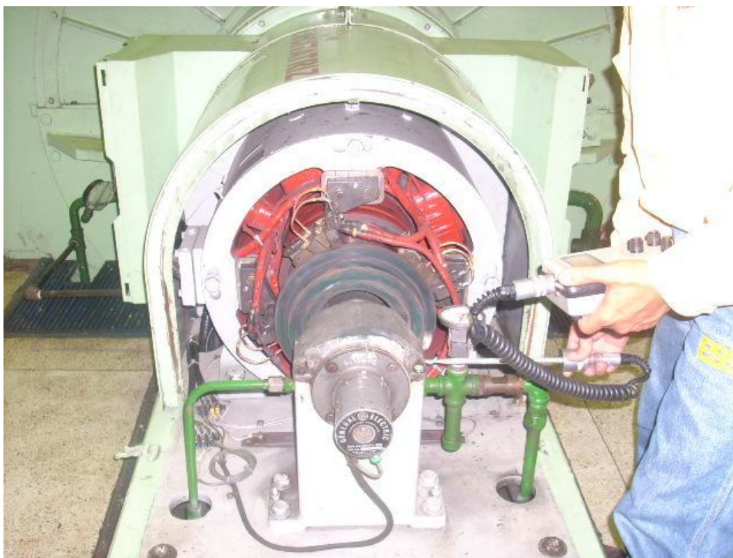
Foto 95. Prueba de vibración horizontal – Turbina 1.
