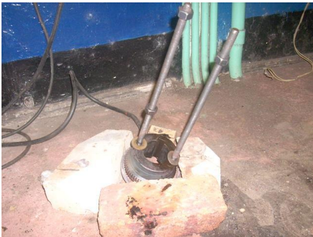
Foto 33. Acople en calefacción para instalar – Motor bomba 1A.
