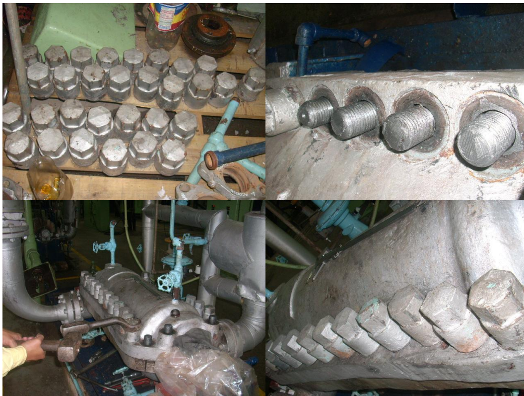
Foto 61. Tuercas de ajuste a la carcasa – Bomba de alimentar caldera 1A.
