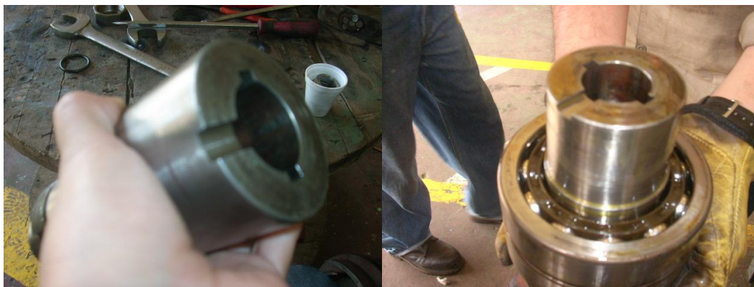
Foto 80. Manzana lado acople, ranura lubricación – Bomba de aceite de baja presión.
