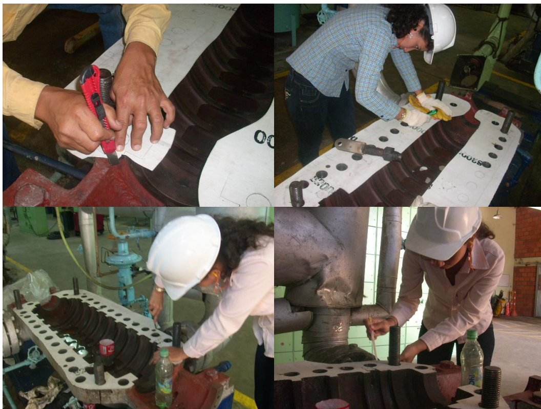
Foto 54. Agujeros de los espárragos y croquis de la cara de la carcasa – Bomba de alimentar caldera 1A.
