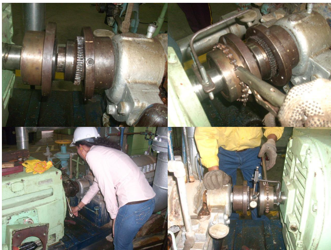
Foto 72. Hombre solo de cadena e indicador de carátula (Alineamiento radial) – Motor bomba de alimentar caldera 1B.
