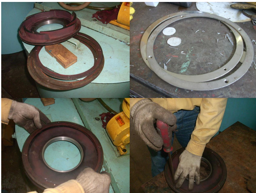
Foto 56. Shims para primera etapa (Ajuste axial de los difusores con respecto a la carcasa) – Bomba de alimentar caldera 1A.
