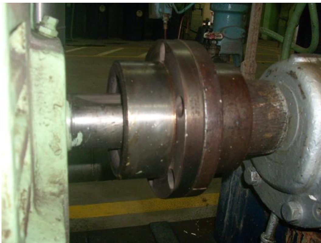
Foto 73. Acople dentado rígido – Motor bomba de alimentar caldera 1B.
