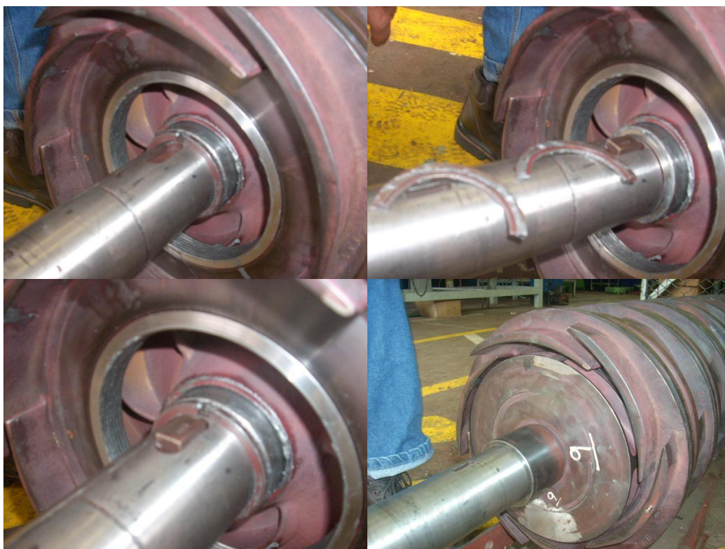
Foto 43. Difusor, chaveta media luna, cuña e impulsor – Bomba de alimentar caldera 1A.
