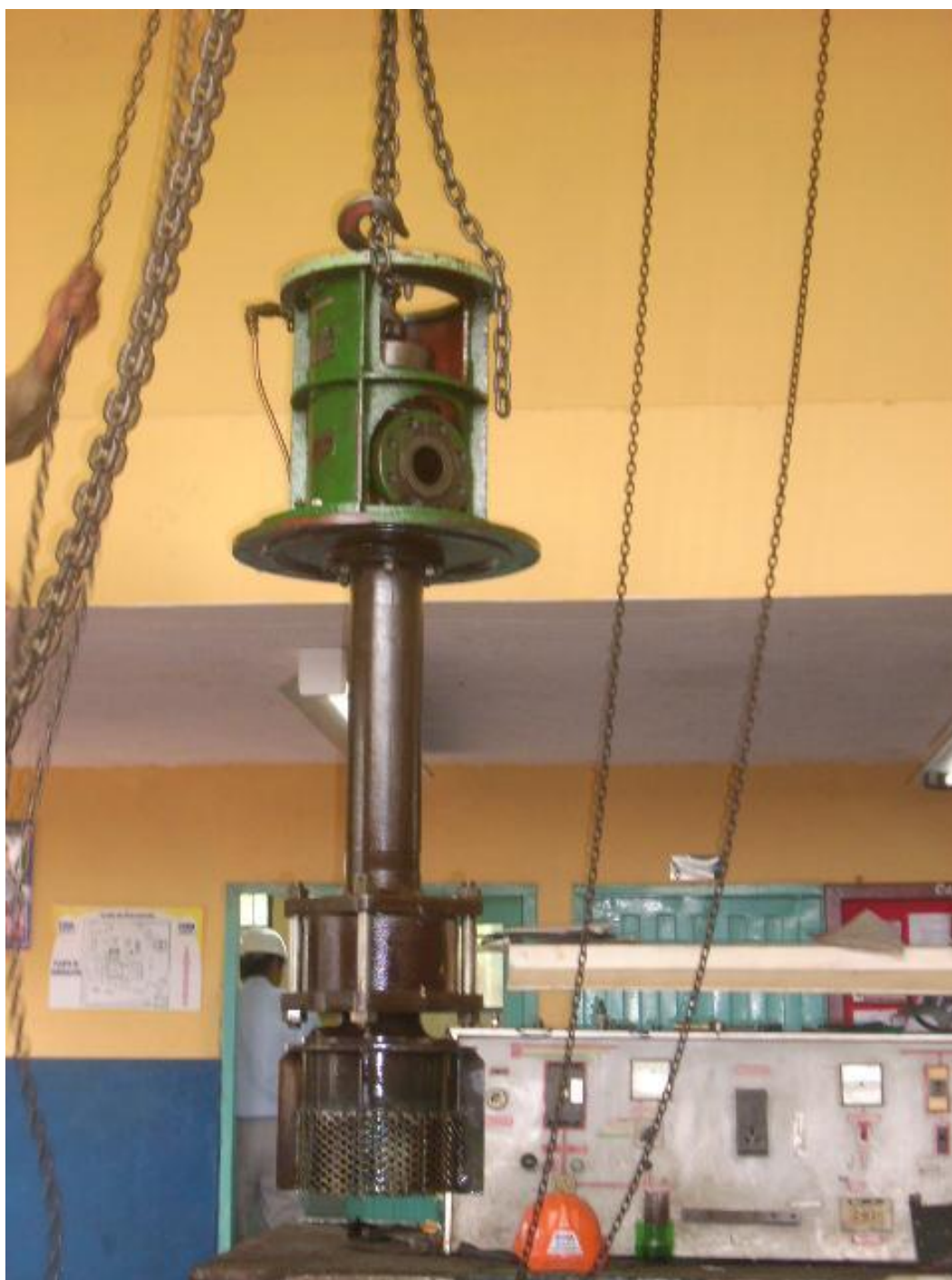
Foto 84. Cuerpo de la bomba, succión y descarga – Bomba de aceite de baja presión.
