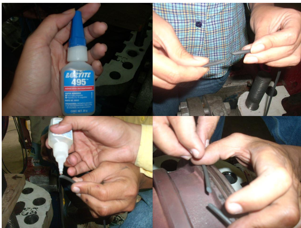
Foto 58. Pegante instantáneo industrial Loctite 495 para unir el viton – Bomba de alimentar caldera 1A.
