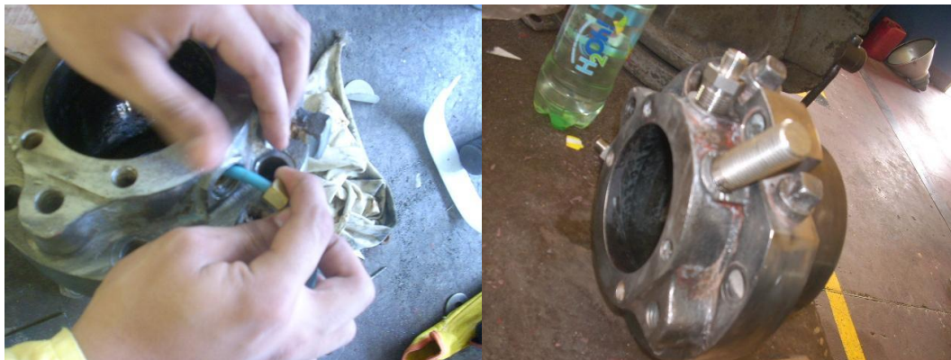
Foto 53. Limpieza del housing o porta empaques – Bomba de alimentar caldera 1A.
