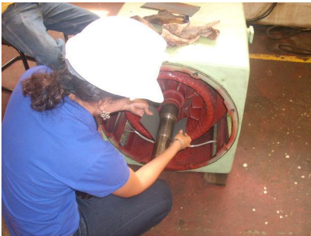
Foto 29. Limpieza para instalar tapas del motor– Motor bomba 1A.
