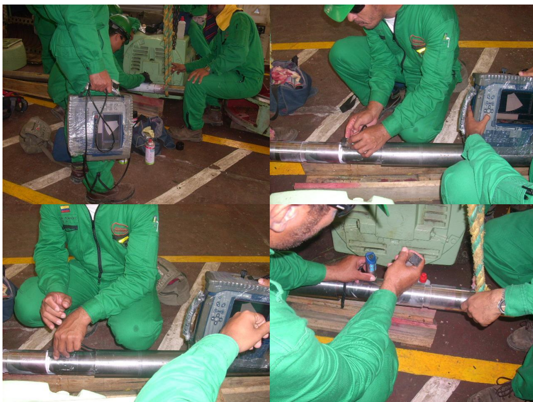
Foto 69. Prueba ultra sonido – Eje lado impulsor bomba de circulación 3-2.
