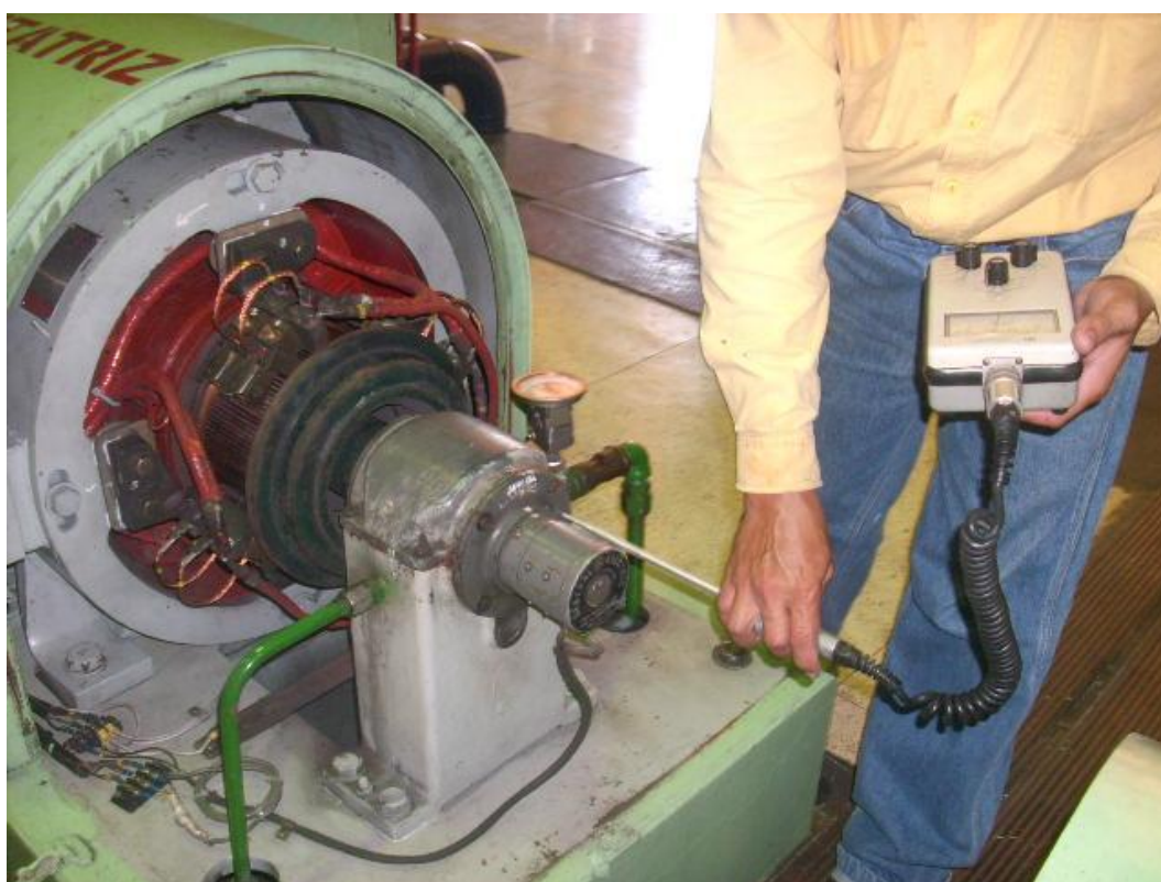
Foto 93. Prueba de vibración axial – Turbina 1.
