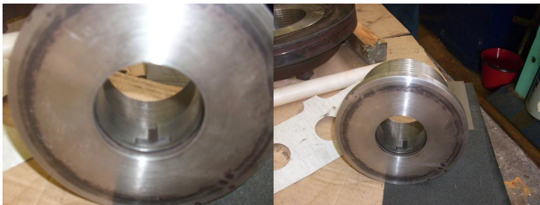
Foto 44. Cuñero y canal para O´ring de viton, Tambor de balanceo – Bomba de alimentar caldera 1A.
