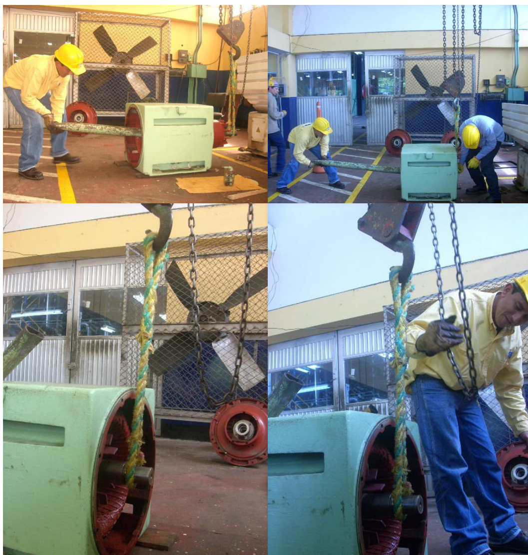
Foto 28. Instalación rotor – Motor bomba 1A.
