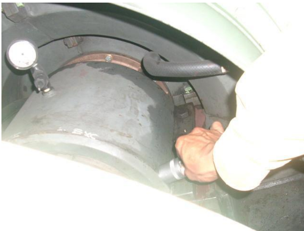
Foto 96. Prueba de vibración horizontal – Cojinete de turbina 1.
