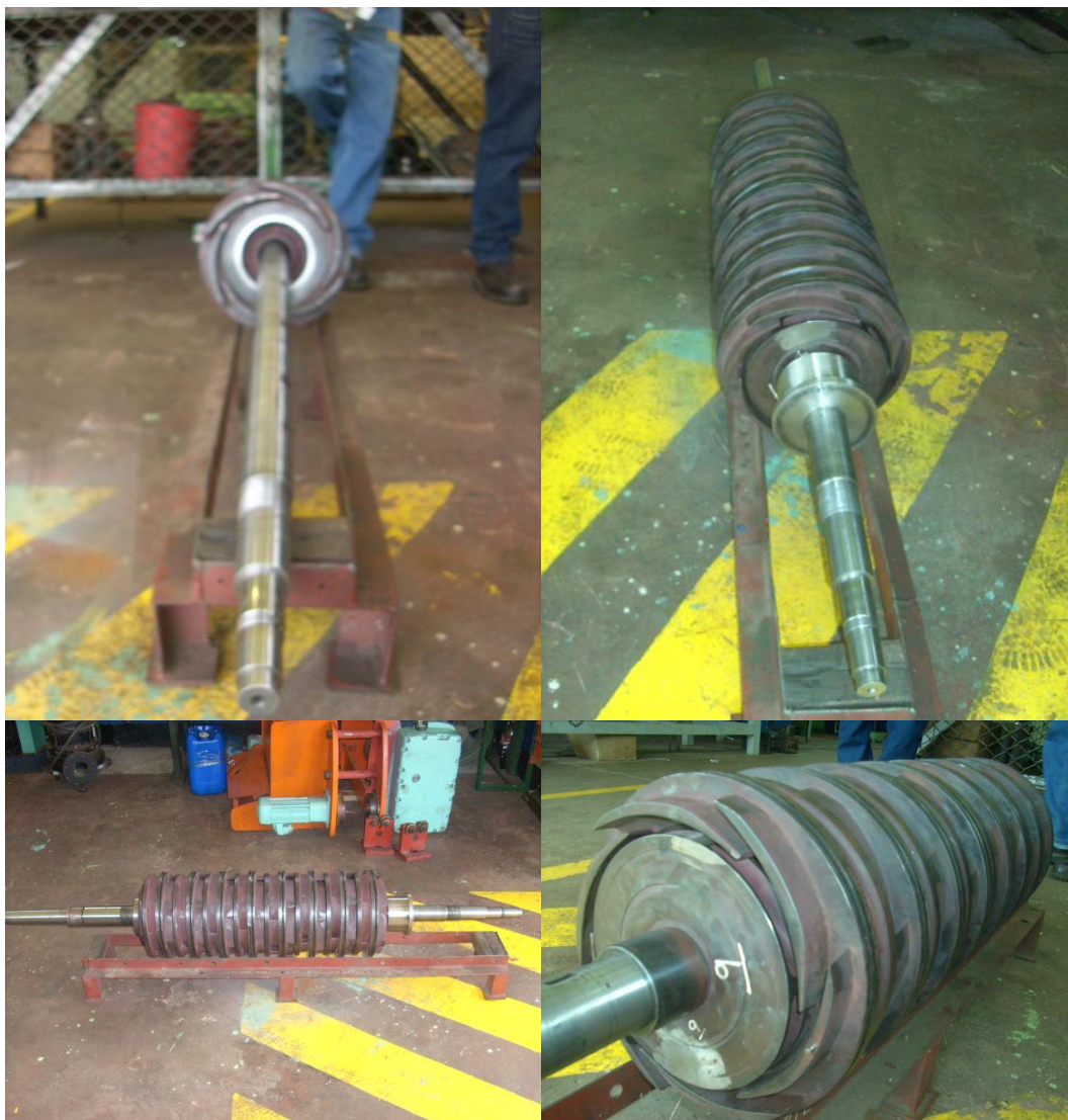
Foto 42. Instalación difusores e impulsores al eje de la bomba – Bomba de alimentar caldera 1A.
