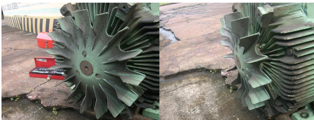
Foto 76. Ventilador del motor del ventilador tiro forzado.
